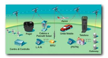
Quando un telefono **IRIDIUM** viene acceso, il satellite più vicino - in collaborazione con la intera costellazione - determina automaticamente la posizione dell'utente e la validità della sua richiesta di collegamento. E' grazie a un crosslink continuo tra satelliti che l'utente puo' raggiungere la sua destinazione, sia questa un altro telefono **IRIDIUM** o una stazione (gateway) di collegamento terrestre.
